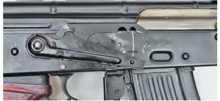
Пылезащитный щиток щели крышки ствольной коробки на автомате А-55
