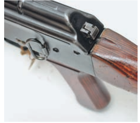
Задняя антабка размещалась на левой стенке ствольной коробки. Пятка возвратного механизма имела защёлку для исключения отделения крышки ствольной коробки при падениях. Обратите внимание на отсутствие хвостовика вкладыша для крепления приклада
