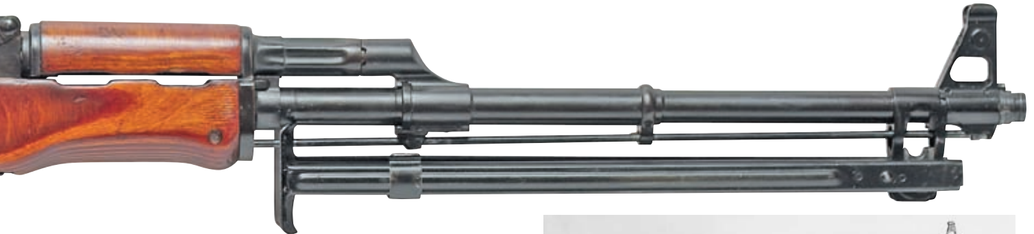
Упор для шомпола основания мушки имел 2 паза для крепления штыка-ножа. Такое конструктивное решение не оправдало себя на войсковых испытаниях и штык-нож получил упорное кольцо
