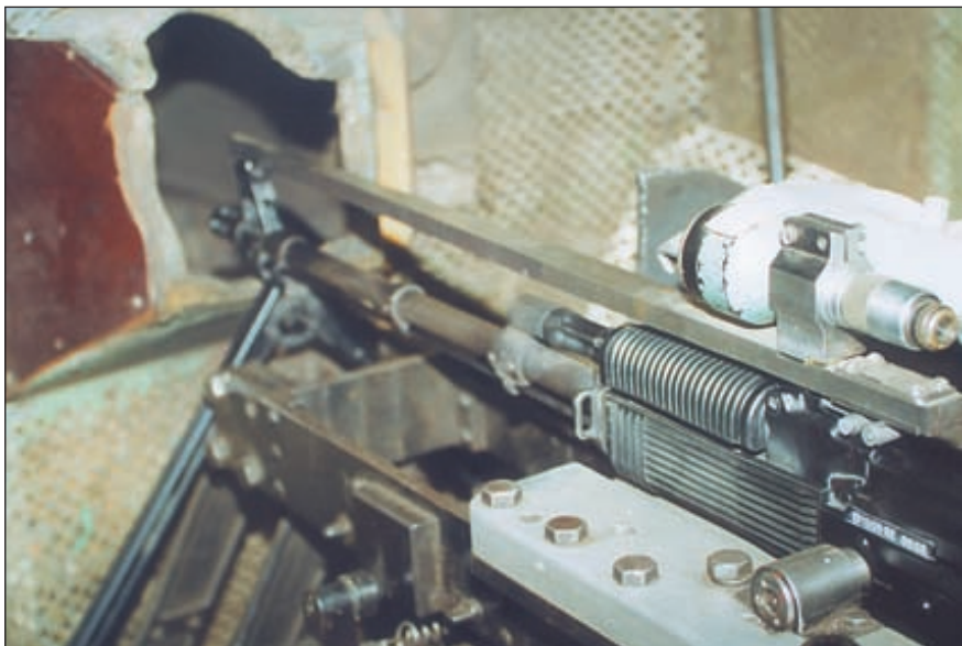
Каждый пулемёт на заводе приводится к нормальному бою сначала с помощью трубки холодной пристрелки, затем стрельбой в тире. Эту процедуру проходят и все без исключения охотничьи карабины, выпускаемые «Молотом»
